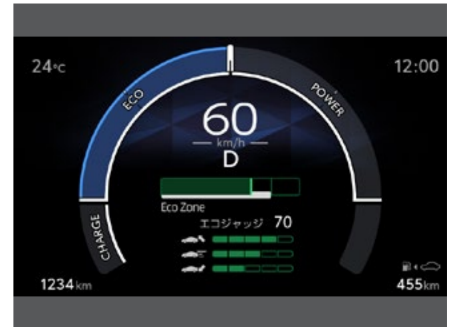
マルチインフォメーションディスプレイ表示例（エコ採点※ ハイブリッド車のみ） ■写真はハイブリッド車。
