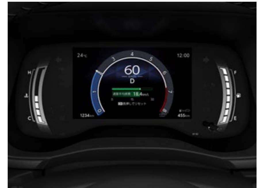
オプティロンメーター+7.0インチTFTカラーマルチインフォメーションディスプレイ ■写真はガソリン車。
