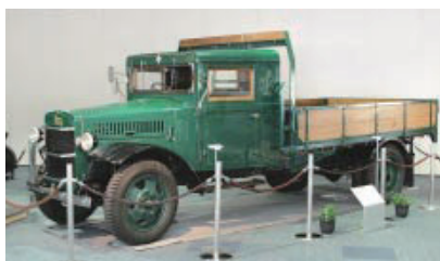
トヨタKC型トラック 1946年（昭和21年） 戦中戦後の1943～47年につくられたトラック。戦時には資材不足が深刻になり、ブレーキは後輪だけ、ヘッドライトは中央に1個だけになってしまった。
