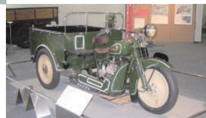
ダイハツ三輪車SA-6型 1937年（昭和12年） 〈早川東助氏より寄贈〉 1930年以来、ダイハツはオート三輪のトップメーカーとして成長。このSA-6型は、500cc、670cc、750ccの3種類のうちの中間タイプ。
