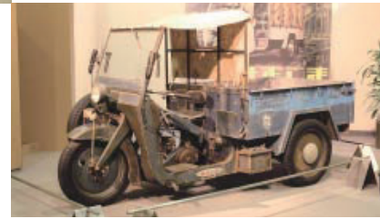
みずしまTM3C型 1949年（昭和24年） 〈三菱自動車(株)三菱オートギャラリーから借用〉 戦後復興期に三菱重工業・水島機器製作所がオート三輪に新規参入。進歩的な設計や、当時としては他にみられない風防ガラスと幌屋根の装備が特長。
