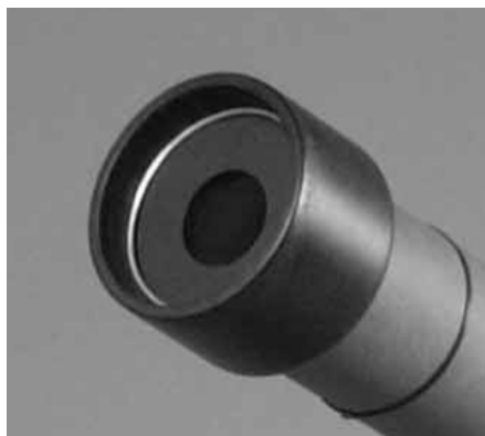
図3 14倍望遠鏡対物レンズの絞り[1] 直径26ミリの絞りが、対物レンズ（外径51ミリ）に取付けてある。
