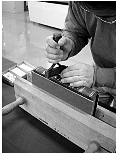
図 10 本の装丁に伝わる革の金箔押しの技法 背表紙の革の上に金箔をのせ、熱した図柄の金型を上から押し当て、金の模様を描き出す 国立国会図書館での作業写真[27]。
