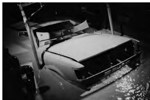
図 4.12 電着塗装（日本ペイント提供）
