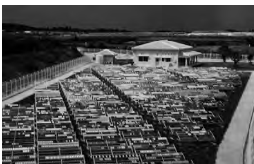
図 2.9 暴露試験場（宮古島）（日本ペイント提供）
