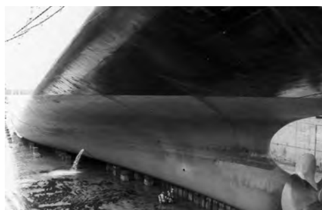
図 5.16 錫フリーの SPC 塗装船の 5 年ノンドッキング後の船底
