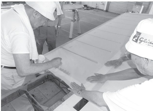
写真6 主翼の羽布貼り作業
