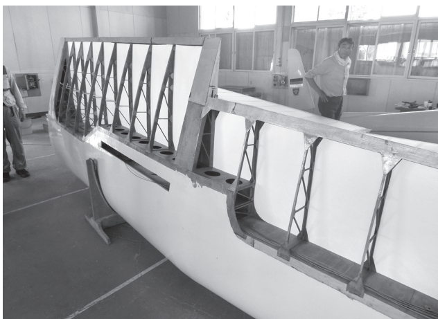
写真7 主翼下面への羽布貼りの状況
