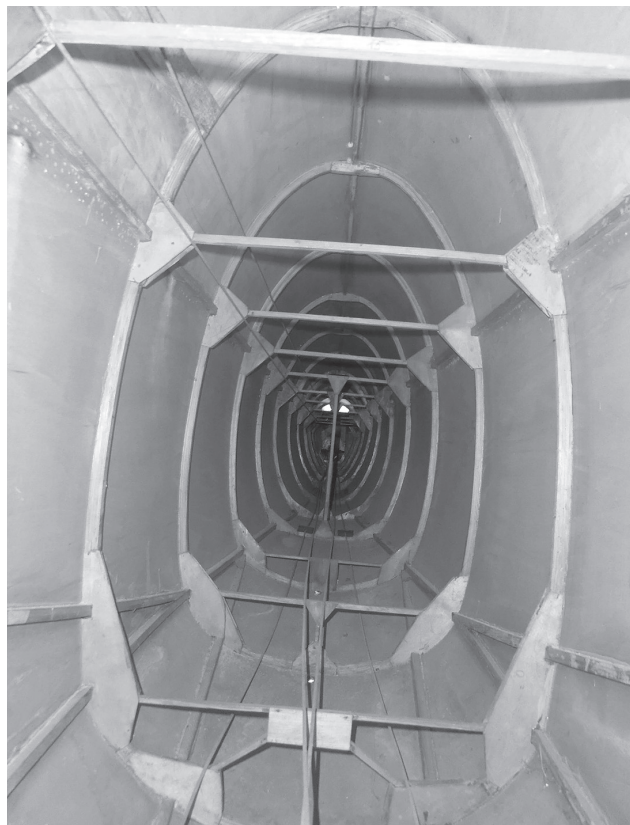
写真8 胴体内部のリブと外皮の合板
