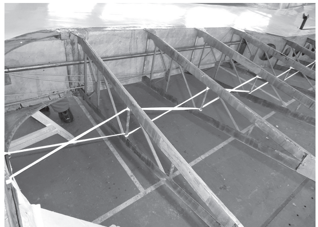
写真5 主翼後縁の構造
