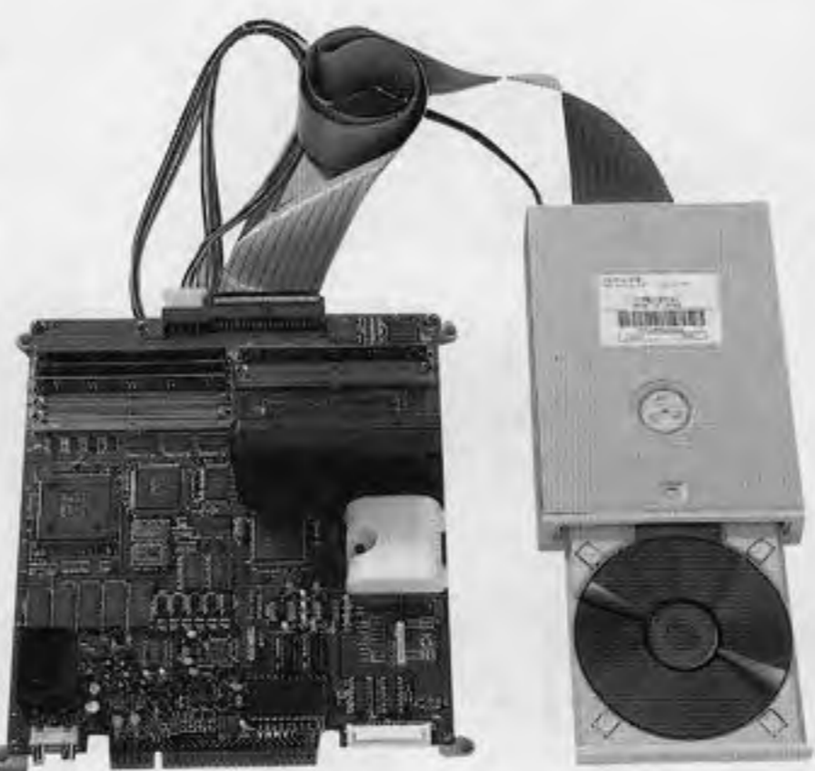
新システム基板「CPS III」。左側のメインボードと右側のCD-ROMプレーヤーを組み合わせる
