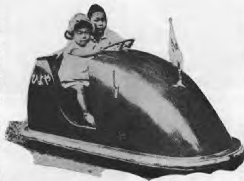
子どもたちに人気のあった豆自動車。6ボルトのバッテリーを使い、時速15キロほどのスピードがあった。自動車前部に係員が輪をかけている部分がある。
