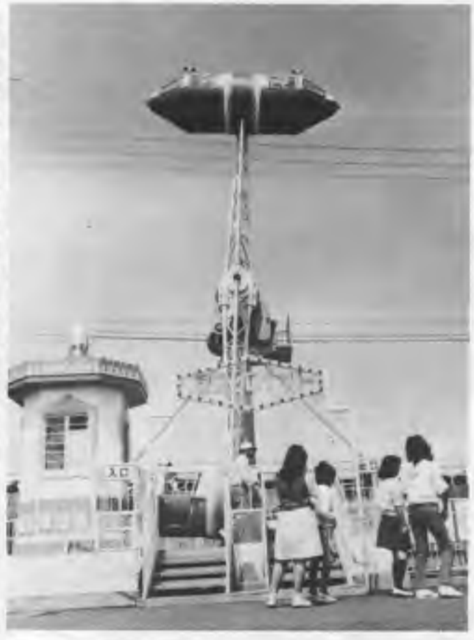
アームに支えられた乗物が垂直回転する「宙返りロケット」
