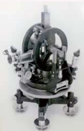
田中館愛橋が考案した当時世界一の精度を誇った電磁方位計（田中館愛橋記念科学館提供）
