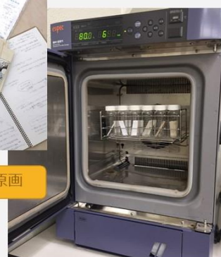
恒温恒湿槽による強制劣化試験
