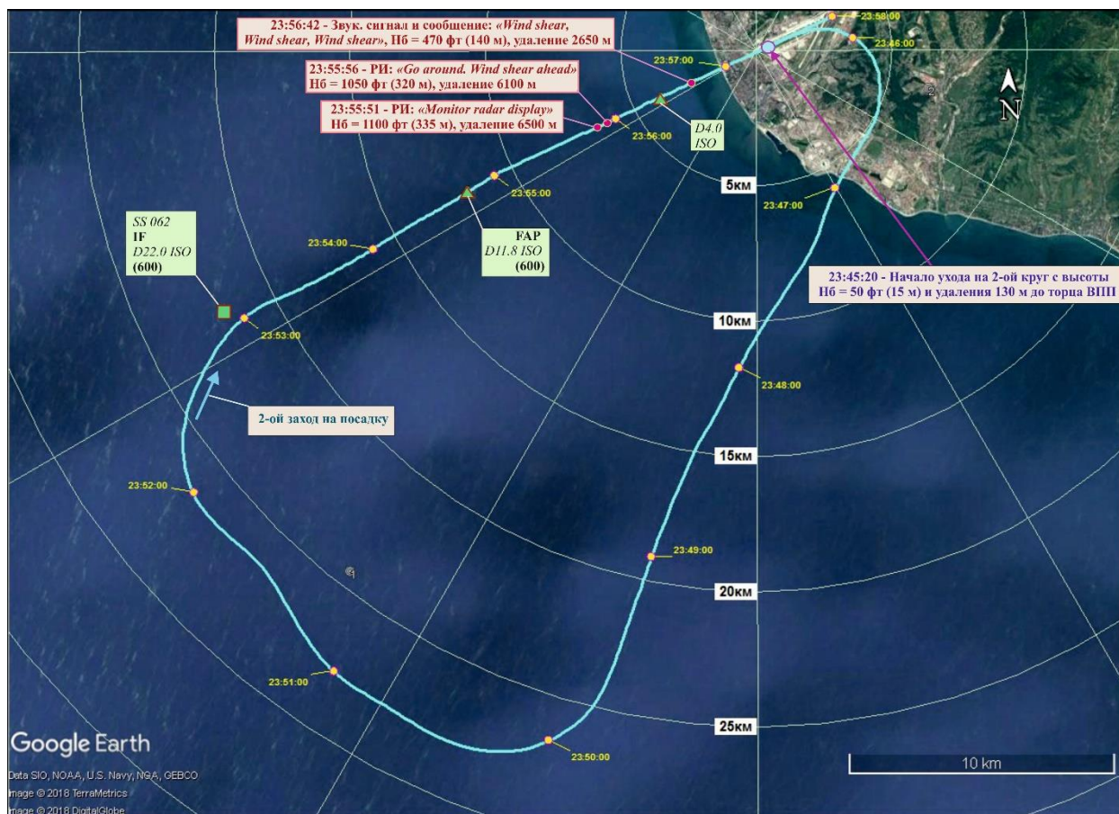
Рис. 5. Траектория ухода на второй круг и повторного захода ВС на посадку
