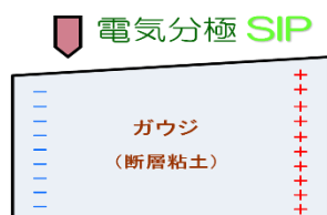
図1 粘土を含むブロックの片側を圧縮したとき現れる典型的な電位分布
