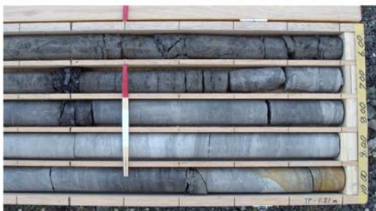
写真.2 コア \gamma 線測定で検出したすべり面
