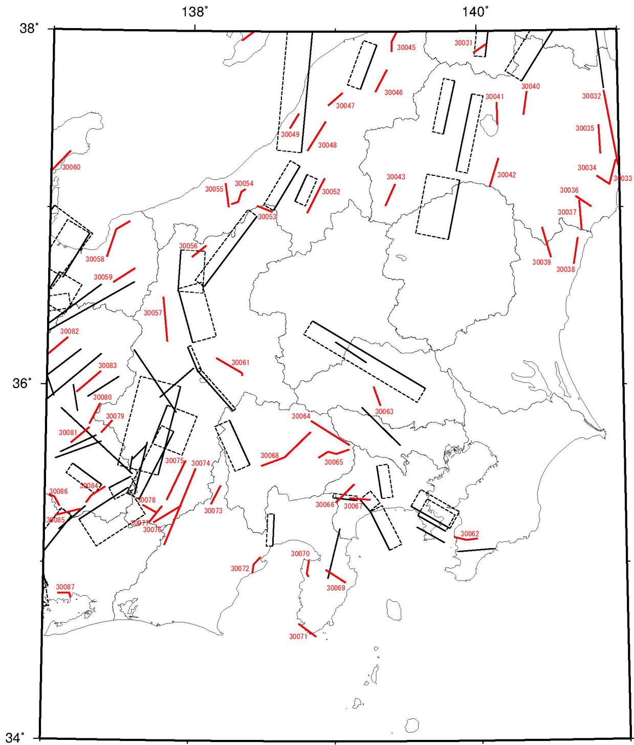
図 2.2.3-1 (その3) 活断層のモデル 赤：主要 98 断層帯以外の活断層のモデル 黒：主要 98 断層帯のモデル
