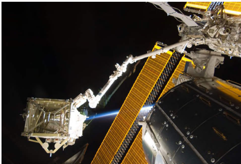
図2.3-7 STS-119で設置が行われたS6トラスの移動作業
