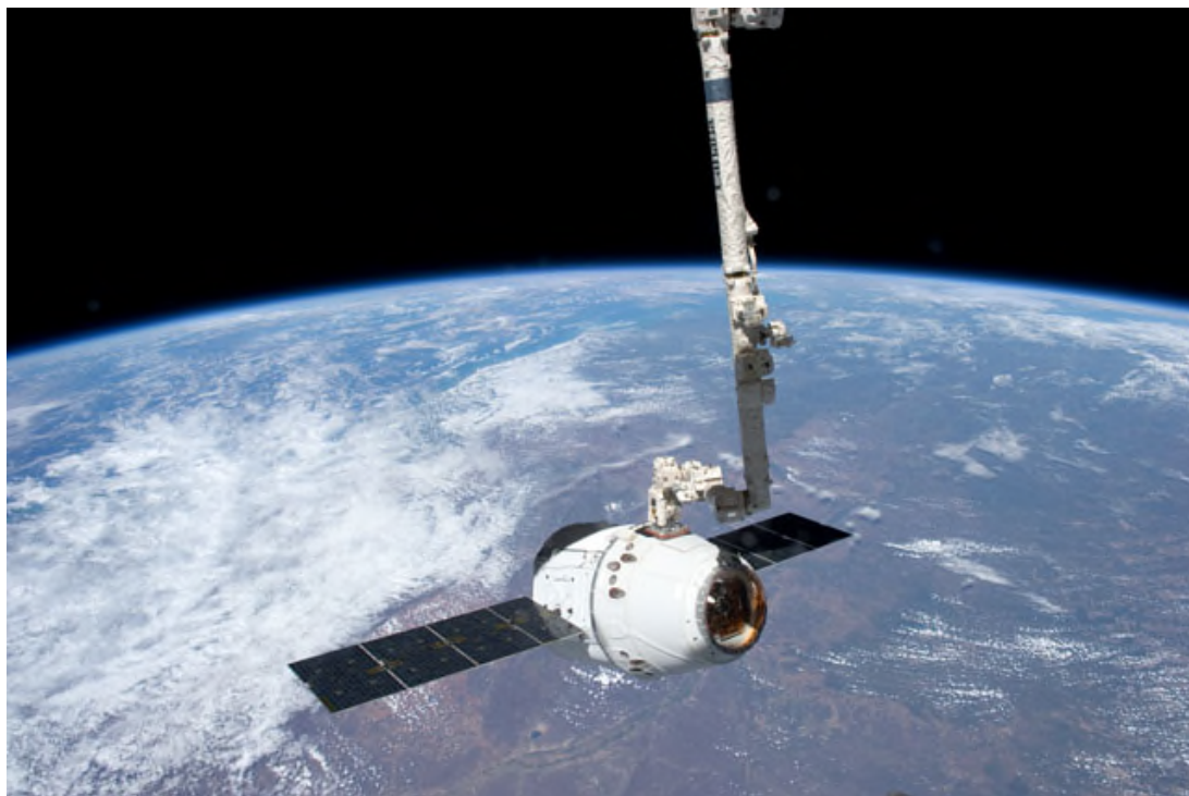
図4.4-2 ロボットアームで把持されたSpace X社のドラゴン補給船(C2+)(NASA)
