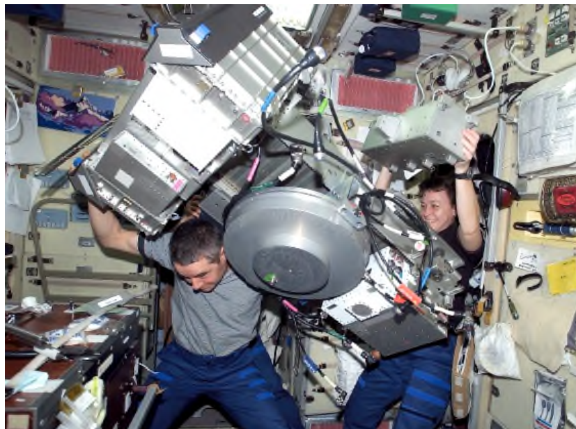
図3.4-2 TVISの修理(床下の機器を取り出した状態:2002年10月)
