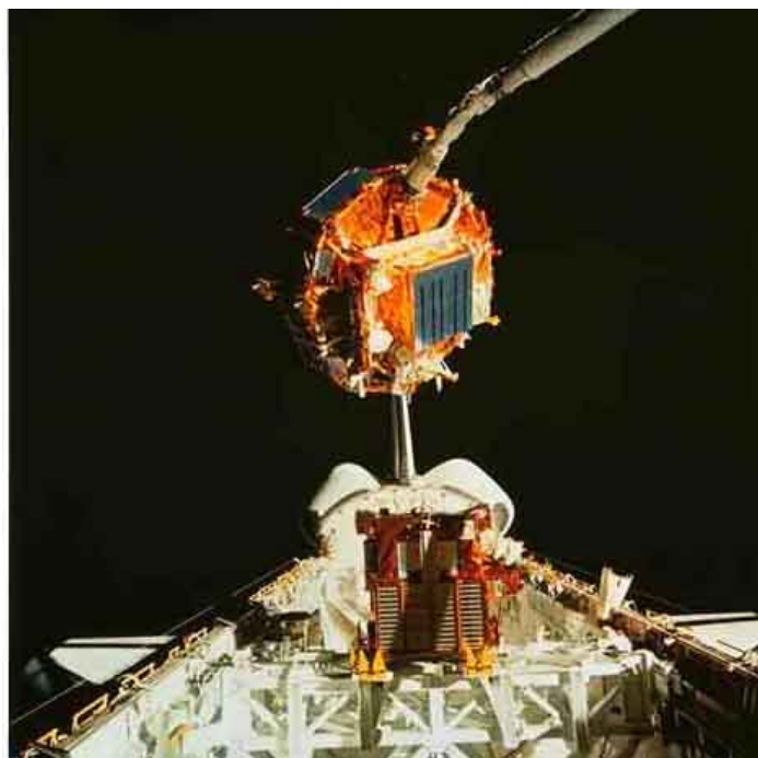
図2.3-4 STS-72ミッションで若田宇宙飛行士が回収した日本のSFU 下側の衛星OAST-Flyerもロボットアームを使って放出と回収を実施
