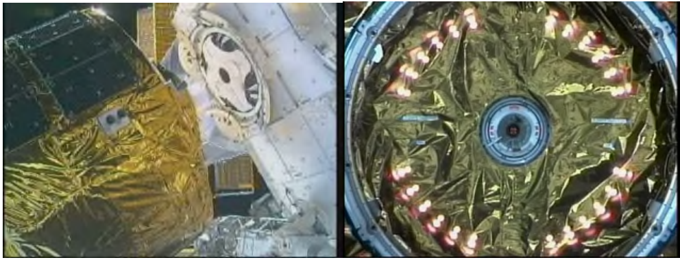
図4.4-6 HTV「こうのとり」到着時の共通結合機構の位置調整作業 (右は、ハーモニーの窓に位置決め用に設置するCBCS (Centerline Berthing Camera System)から撮影した映像。ドラゴンとシグナスも同様の作業を行います。)
