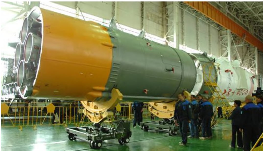
図4.3-1 第3段ロケットとソユーズ宇宙船を収納したペイロードシュラウドの結合作業 (RSCエネルギー社)
