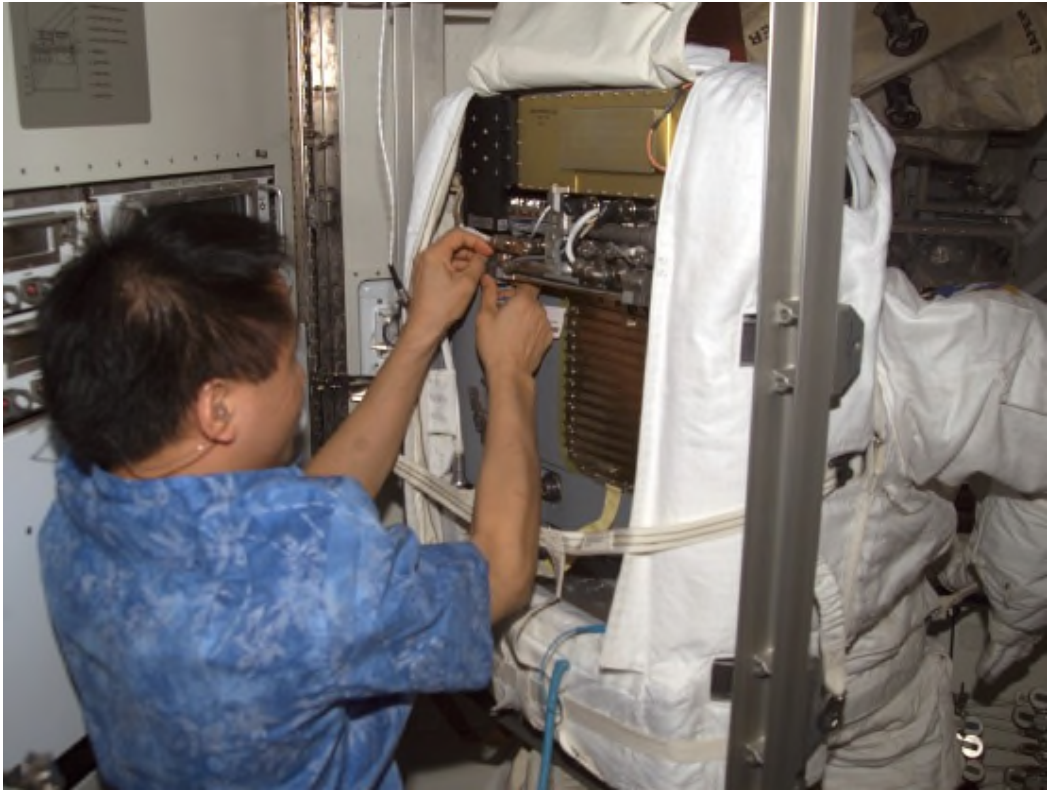
図3.4-16 米国の宇宙服の背中の機器のメンテナンス(定期保全)
