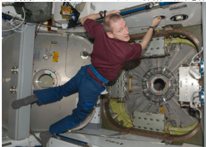
図4.4-7 共通結合機構(CBM)の2枚のハッチ(ISS側のハッチを開けた状態)
