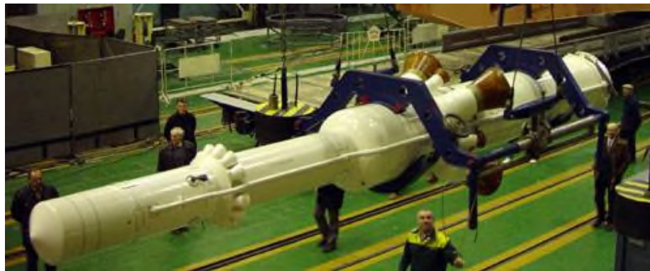
図2.7-1 ソユーズロケット先端に装着される緊急脱出用ロケット(RSCエネルギー社)
