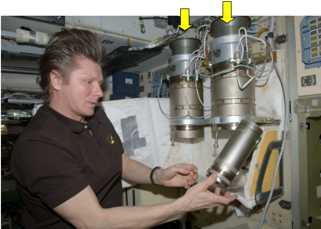
図4.2-2 ズヴェズダ内に設置されているSFOG容器2本(矢印)
