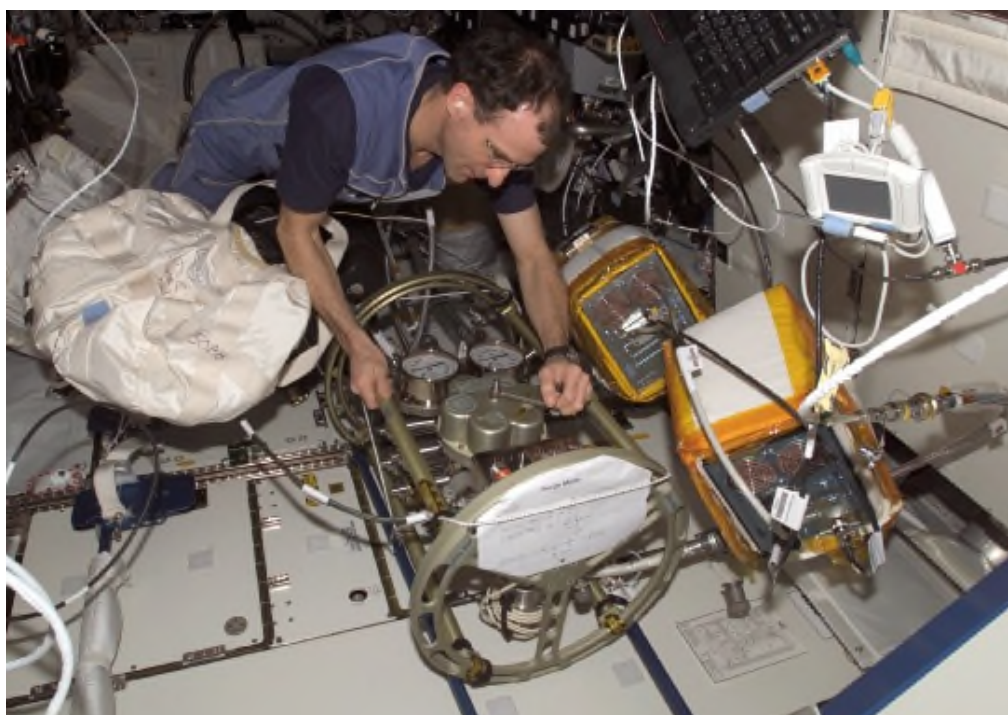
図3.4-8 デスティニー内での熱制御系の冷却水の補充作業
