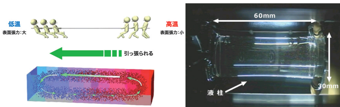
図4.1.1-1 マランゴニ対流の原理(左)と軌道上実験で作られた60mmの液柱(右) [RYUTAIラックの流体物理実験装置を使用]
