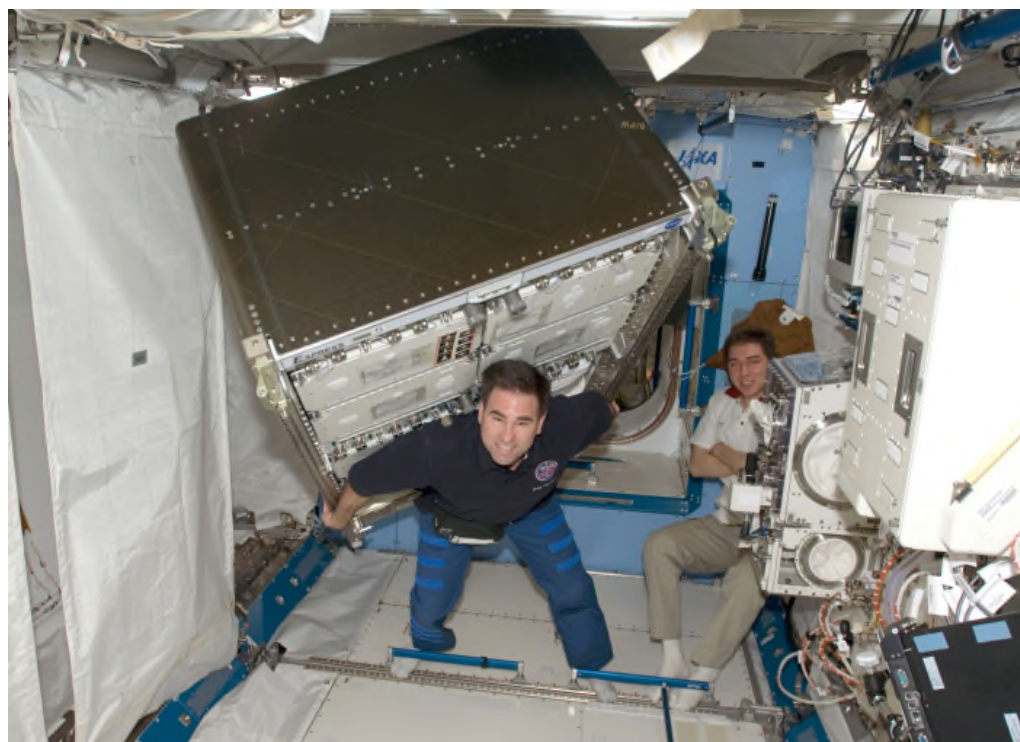
図3.4-13 「きぼう」内でのラックの搬入・設置作業(上・下)
