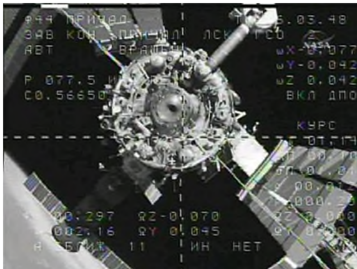
図2.4-1 ドッキング時の映像(カメラ映像にKursからのデータを重ねて表示) (接近速度、ISSとの距離、姿勢の変化、時刻などを表示。中心線がドッキングポートの中心からずれるのは、そこにドッキングターゲットがあるためであり異常ではありません)
