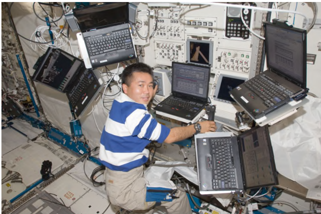
図2.3-10 きぼうのロボットアーム操作卓での作業 確認すべき項目が多いためラップトップを多数集めて作業をやすくしています
