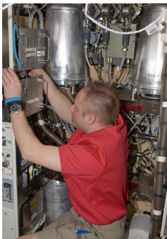
図3.4-6 米国のトイレ(WHC)の内部機器の組立作業
