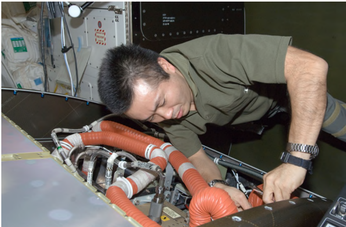
図3.4-15 ラック背面からアクセスしての修理・保全作業
