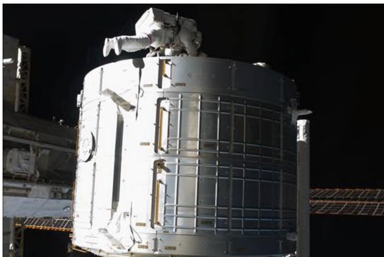
図 1-5 船内保管室(外観)
