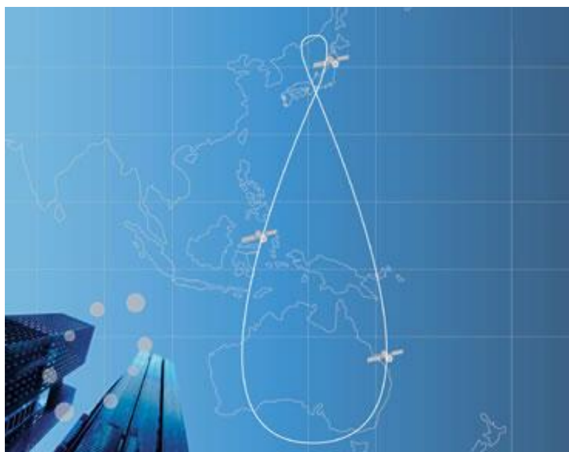
図4：準天頂衛星の軌道（JAXA HP より）
