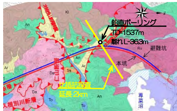
図-3 鉛直ボーリング、比抵抗二次元探査位置図
