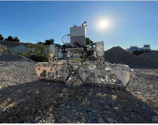
月極域探査機 LUPEXローバの屋外フィールド試験の様子
