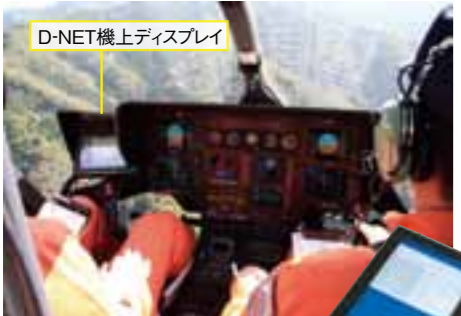
D-NET機上ディスプレイ 神戸市の消防防災ヘリコプターに取り付けられたD-NET対応端末(写真左/提供:神戸市航空機動隊)と、災害時に機内に持ち込めるD-NET対応端末(写真右)
