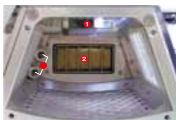
飼育ケージの内部。 ①照明・カメラ ②給餌口 ③給水口(2個)
