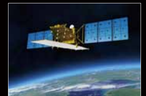
陸域観測技術衛星2号「だいち2号」能力が大幅に向上したLバンド合成開口レーダPALSAR-2を搭載しています。衛星本体下の白い部分がPALSAR-2のアンテナです。
