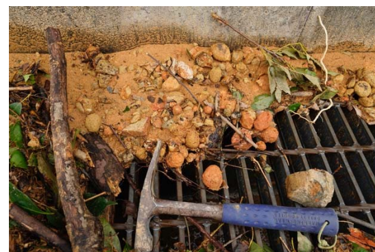
崩土の礫は旧風化の砂岩と頁岩
