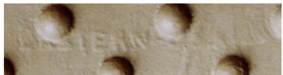
▲写真11 使用されている鋼材の刻印
