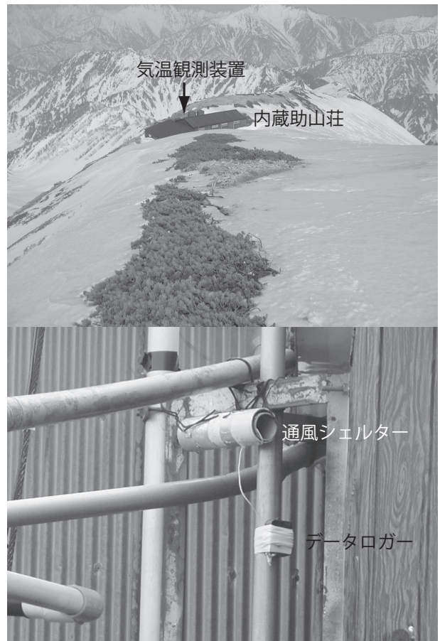
図 2 気象観測点の写真。上は無人氣温観測を行っている内蔵助山荘。下は通風シェルターとデータロガー。
