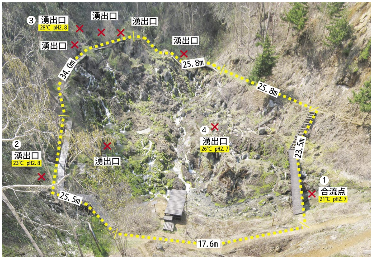
図10 穴地獄全景(測量・水温・pH調査) 2011.12.7 気温2℃
