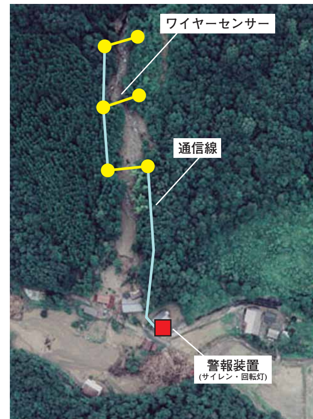
警報装置施工例(上重行地区)
