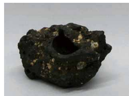
黒坪川の土石流堆積物に含まれていたたら製鉄の残滓であろう鉄屑
