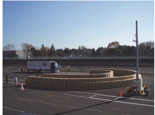
写真 2-3 実験コース①-1（両側壁あり：10tトラック）
