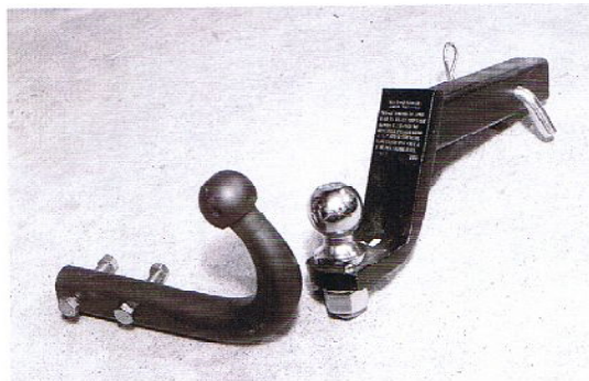
左がヨーロッパタイプの固定式で、右はアメリカタイプ。ヒッチボール径の差は0.8mmしかないが、共用は安全上から避けるべきだ
