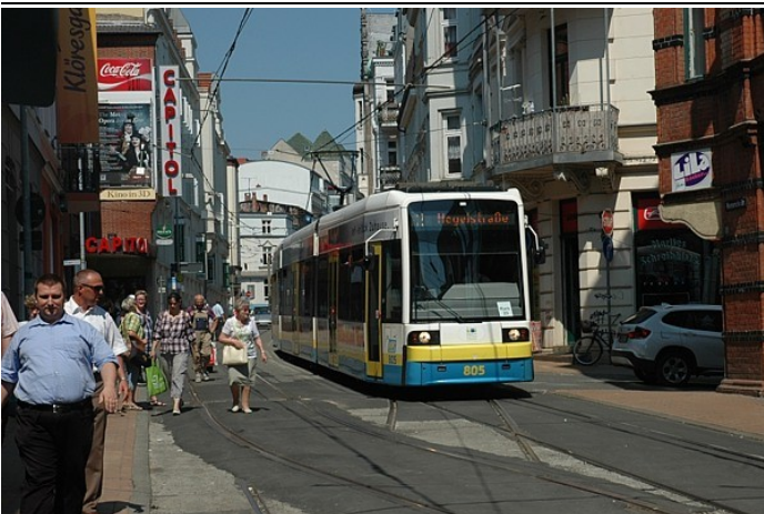
Skład 805+822 na linii 2 w relacji Lankow Siedlung – Hegelstrasse podczas obsługi tymczasowego przystanku Martinstrasse. Warto zauważyć, że skład stoi na torze w kierunku przeciwnym do właściwego, a na zdjęciu widoczna jest m.in. zaasfaltowana nakładka (rozjazd nakładkowy).
