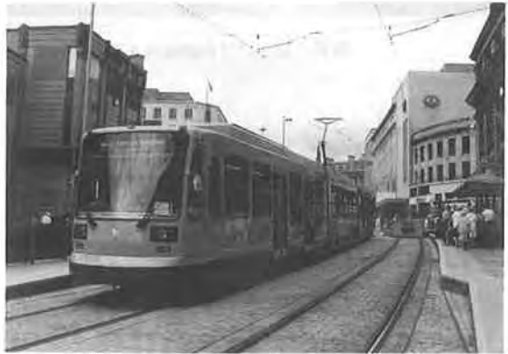
写真-10、11 ▲▼イギリスのシェフィールドにこの春開通したLRT。電車床面は、低い安全地帯式プラットフォームと面一になっているのが分かる。
