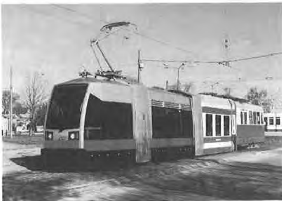
写真-13、14 ▲▼オーストリアのウィーンでテスト中の「超低床車」。路面から床面まで152mm。足の短い日本人でもラクラク。量産第1号が登場する頃だ。
