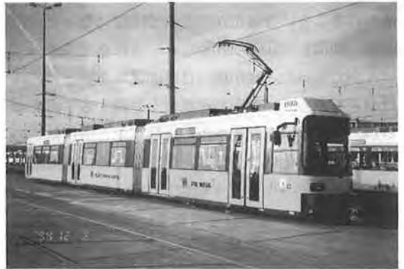
写真一7、8 ▲▼ベルリンに秋から走り始めた3車体100%低床車。120編成の大量発注だ。基本仕様はプレーメンと全く同じで、2車体接続(長さ約18m)も可能な設計
