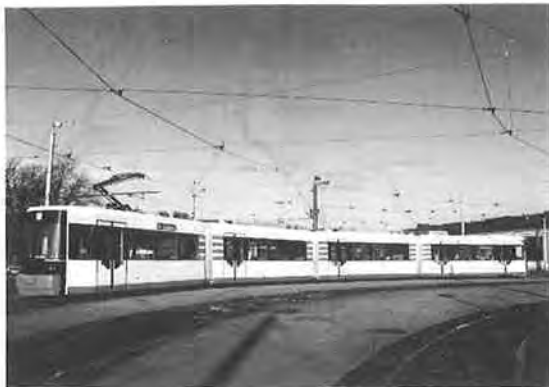
写真一6 ドイツのプレーメンに投入されつつあるしょうしゃな4車体接続の100%低床車
