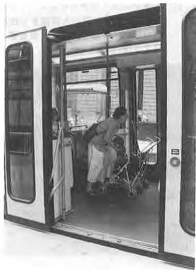
写真-10、11 ▲▼イギリスのシェフィールドにこの春開通したLRT。電車床面は、低い安全地帯式プラットフォームと面一になっているのが分かる。
