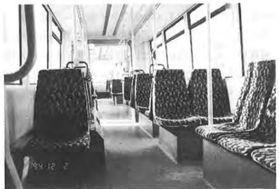
写真一7、8 ▲▼ベルリンに秋から走り始めた3車体100%低床車。120編成の大量発注だ。基本仕様はプレーメンと全く同じで、2車体接続(長さ約18m)も可能な設計
