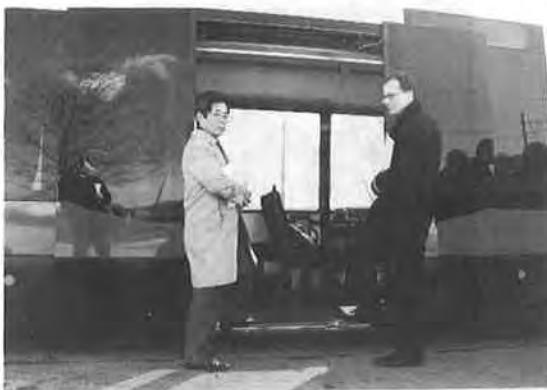
写真-13、14 ▲▼オーストリアのウィーンでテスト中の「超低床車」。路面から床面まで152mm。足の短い日本人でもラクラク。量産第1号が登場する頃だ。
