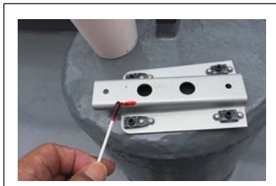
綿棒等で探傷箇所塗る 余分な面には塗らない スプレーしては洗浄処理 が大変になります
