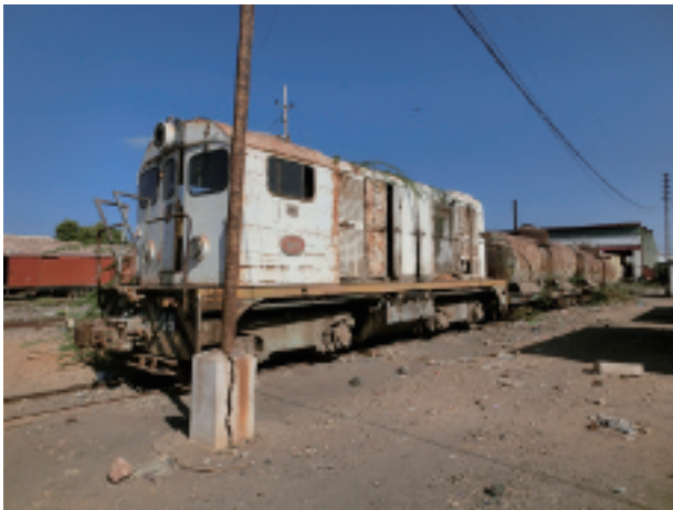
写真-15 タンク車を牽引するアルストム社のBB05型ディーゼル機関車。車体には錆が出ていて、まるで車両の墓場である。(東を見る。2015年4月21日)
