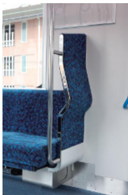
大型袖仕切と出入口横スペース
