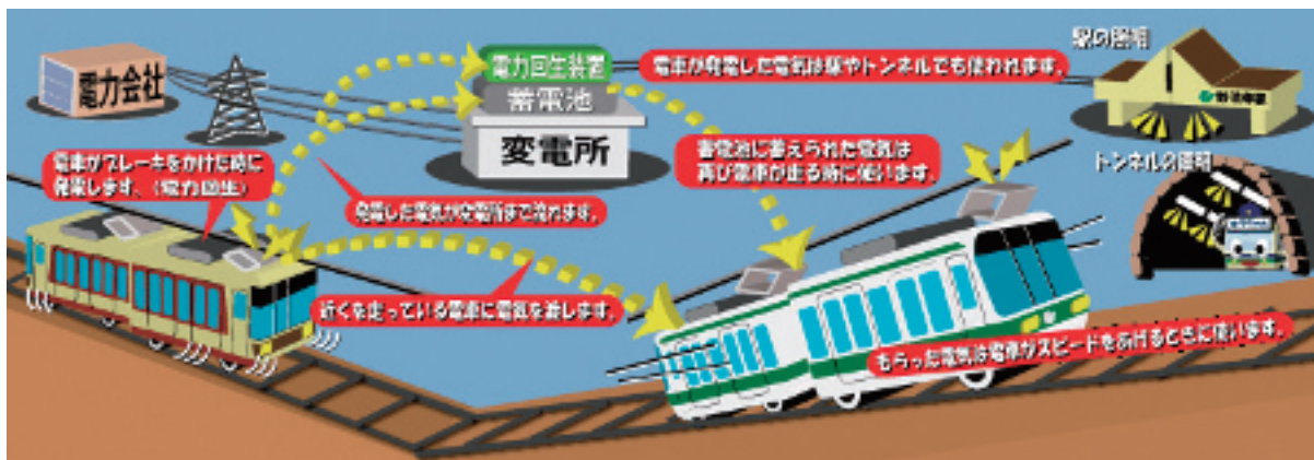
図-3 回生電力のイメージ図
