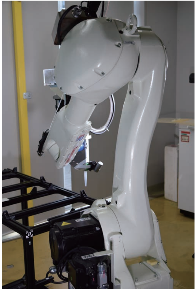
航空機の翼の組立を自動化するロボット Robot for assembly of wings of aircrafts
