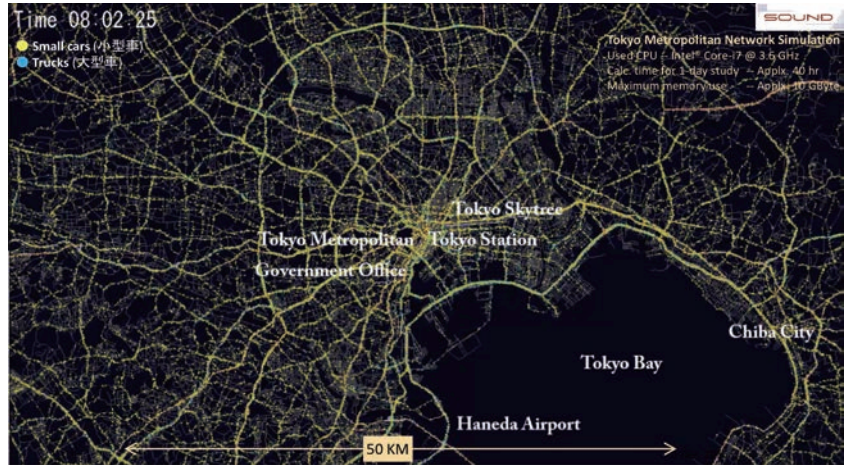
東京都市圏三環状道路概成時の交通状況推定のための大規模ネットワーク 交通流シミュレーション Large-scale network traffic simulator for estimating the traffic situation after the construction of the Tokyo Metropolitan Urban Expressway Rings
