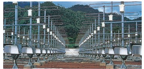
インドネシア共和国西スマトラ州の赤道直下に設置されている赤道大気レーダー。規模はMUレーダーと同程度。
