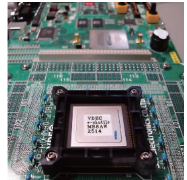
新しい再構成アーキテクチャの試作チップ (65nmプロセス)を搭載したボード
