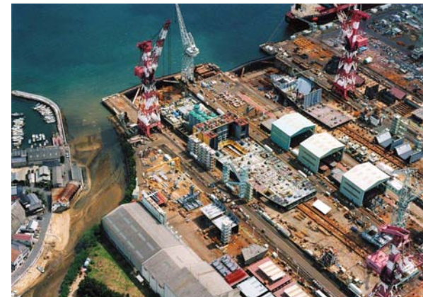
造船所で建造が進む全長210m、幅38mの「ちきゅう」。中央にムーンプール(開口部)が見える
