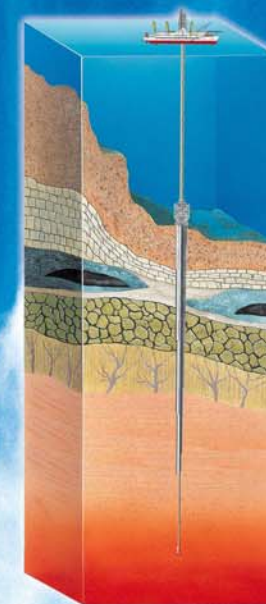
科学掘削船としては初めてのレーザー掘削システムを搭載した「ちきゅう」は、安全に大深度掘削が実施できるとともに、確実な試料の採取を可能にした
