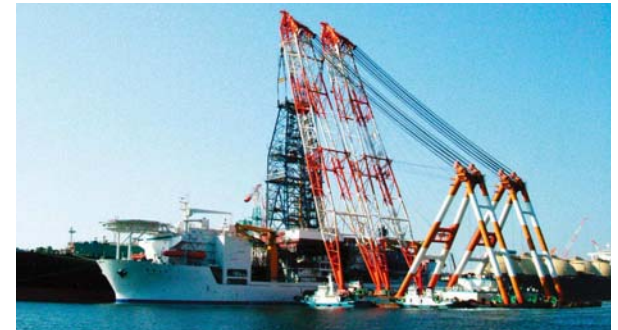
高さ約92mのデリックが、日本最大級のクレーン船を使って搭載された
