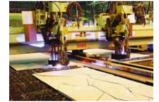
レーザー切断機による鉄板の切断
