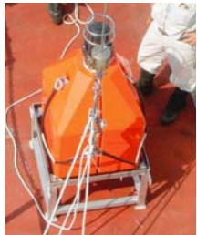
音響測位のため海底に設置するトランスポンダ
