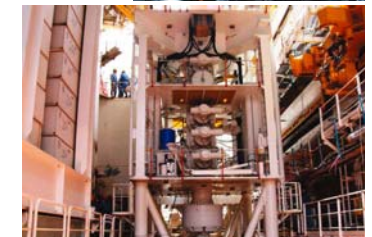
2004年4月、噴出防止装置を船上に搭載
