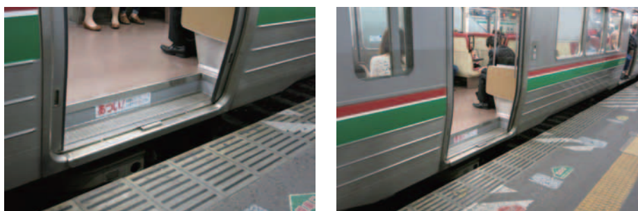
J R 東日本 719 系 0 番代車両（床面高さ 1180mm、ホーム高さ 760mm）
