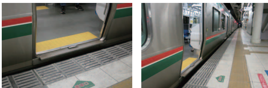
J R 東日本 E721 系車両（床面高さ 950mm、ホーム高さ 920mm）
