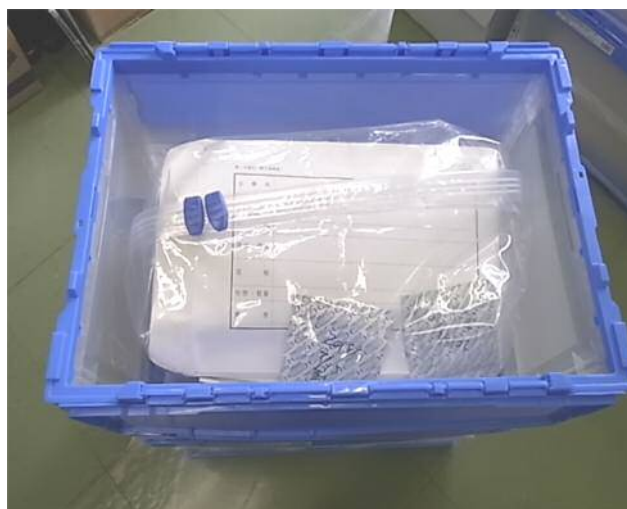
袋の中に入れて固形薬剤で燻蒸する「モルデナイベ」での燻蒸の様子
