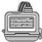
電源投入後、約10分間は心電計のモニターで心電図波形を確認できます。ここで ON ボタンを押すと、1回押すごとに1ch→2ch→1chと表示する波形のチャンネルが切り替わります。必ず両チャンネルの波形を確認しましょう。波形が表示されない場合は、電極装着の不良か心電計本体と電極コードの接続が出来ていない可能性があります。一度電源をOFFにしてもう一度確認して下さい。
