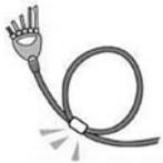
電極は浮かないようにしっかり貼り付けましょう。延長コードの”たるみ”は心電図が乱れる大きな原因となります。使用する場合は、余ったコードをループ状にしてまとめると患者さんの動きの邪魔にならず、波形も比較的安定します。また、心電計本体も出来るだけ体幹で固定する方が波形は安定します。
