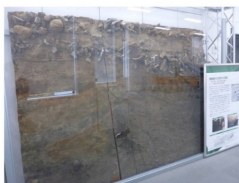
写真2 歴史地震による液状化痕跡「剥ぎとり展示」
