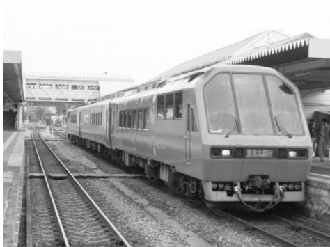
図-6 キハ58・28形を改造して作られた キハ59・29形ジョイフルトレイン「けんじ」
