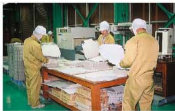
▲型抜きした用紙は人の目と手で検品。検査機器との併用で品質安全に万全を期している
