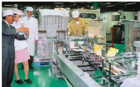
▲型抜きされた用紙は成型ラインで次々と自動成型されていく。微妙な折り加工やのり付けもすべて自動化。高品質で生産性の高い最新機器は同社の自慢の1つ
