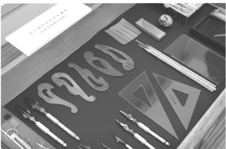
杉本氏が原字制作のために使用した用具類。上段左に五枚並んでいるのが雲形定規。その左に二つ並んでいるのが双頭烏口です。三角定規の右に三種類の毛筆。その上に基準線幅測定用として用いた自作のゲージ。その右にあるのが烏口を研ぐオイル・ストーンです。
