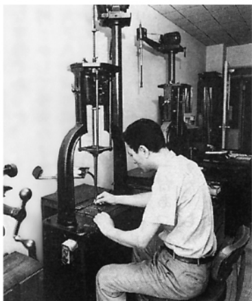
ベントン母型彫刻機。奥に見えるのは国産の母型彫刻機。
