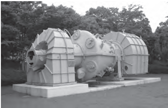
登録候補 No.2: MW-171 形ガスタービン(初号機) 〔三菱重工・高砂製作所〕
