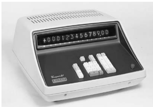
写真4.5 最初のシリコントランジスタ機 CS-20A
