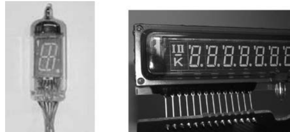
写真4.18 左：単管 右：平面多桁管
