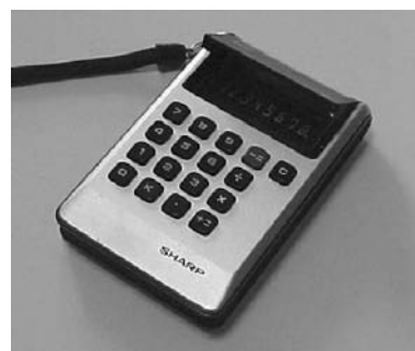
写真4.21 最初の液晶表示機 EL-805
