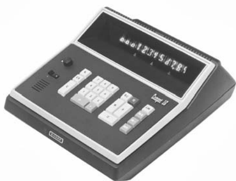
写真4.7 最初MOS・IC機 CS-16A
