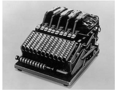
写真2.13 電磁計算機（カバーなしの状態）
