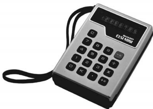
写真4.12 最初のCMOS-LSI機 EL-801
