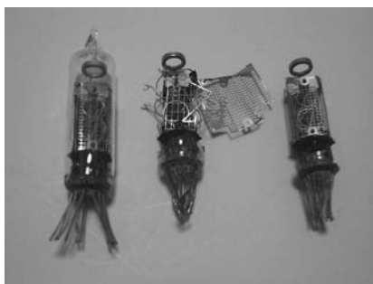
写真4.17 ニキシー管を開けた状態
