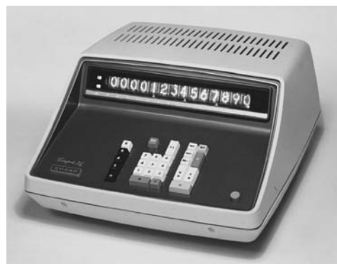
写真4.6 最初のIC機 CS-31A
