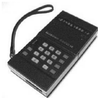
写真4.20 初のLED表示機 LE-120A
