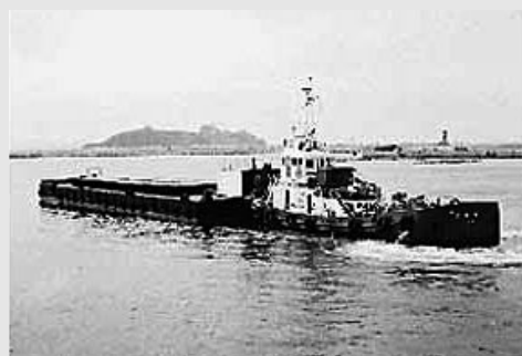
図7 台船に積載された水とタグボート
