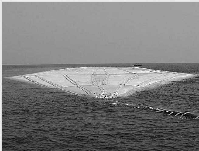
図6 水バッグを用いた水輸送の状況
