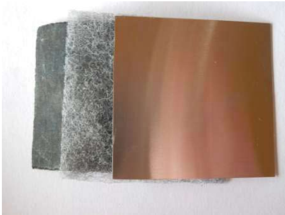
Pic3 電池構成（下から正極材・セパレータ・マグネシウムの順）
