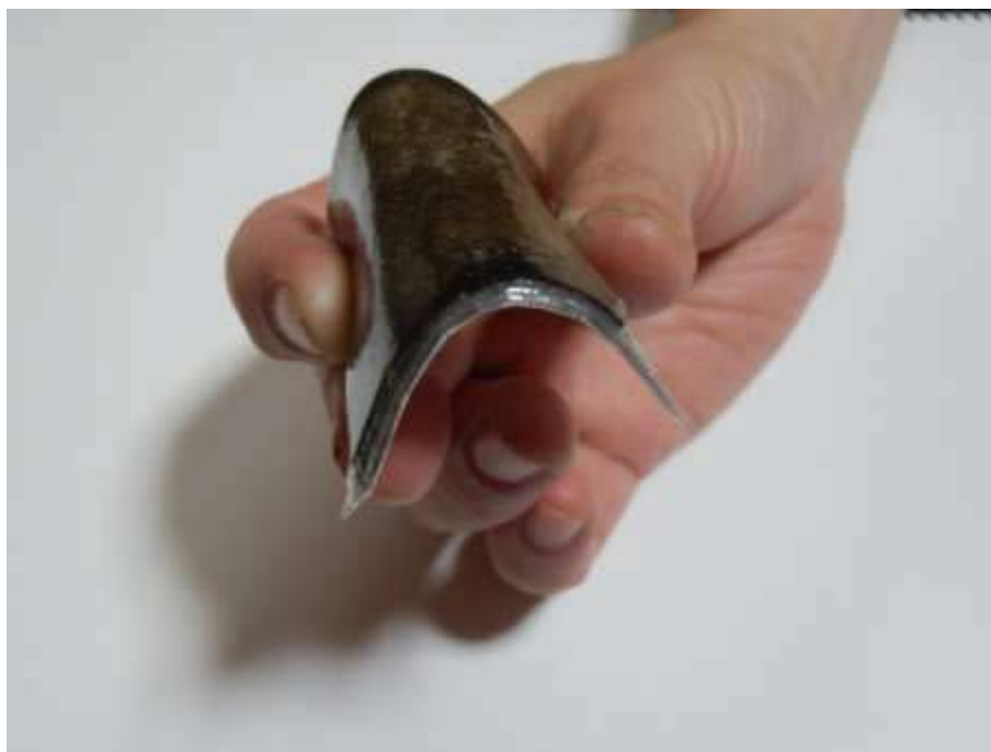
Pic2 フレキシブルマグネシウム海水電池の外観写真 (厚さ 2mm)
