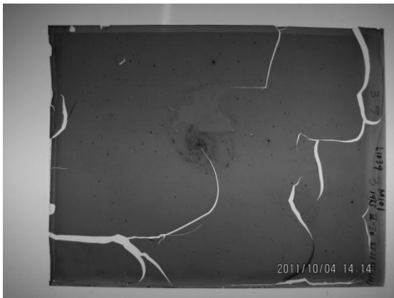
写真 5 全面剥がれている乾板①
