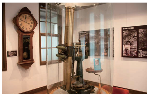
図3：Z項発見時に使用された眼視天頂儀1号機
