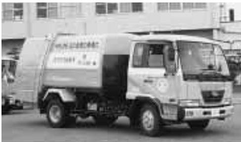
導入が進む、環境への負荷が少ない天然ガスごみ収集車
