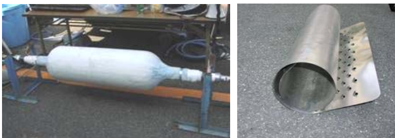
拡張用パッカー 形状保持板 図-2 拡張に使用する器具
