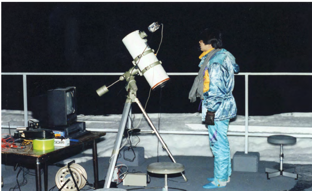
図2 観測風景。口径20cmの反射望遠鏡に工業用ビデオカメラを取り付け、ビデオデッキにつないだだけの簡単なものである。
