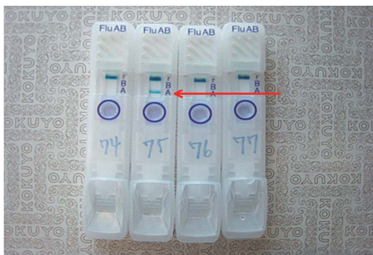
図10 エスプライン ® インフルエンザA&B-Nによる馬インフルエンザの診断。赤矢印で示すようにAのところを青い線がみられたら陽性。本写真では、75番が陽性で、74、76および77番は陰性と判定される。
