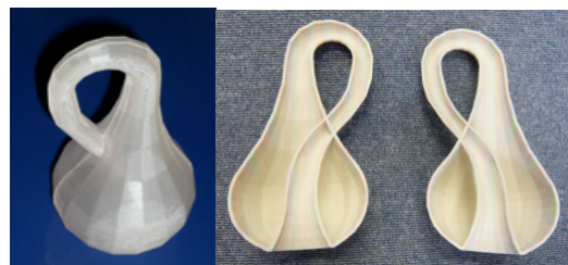
図4 クラインの壺 (左) とその分割模型 (右) 左: 光造形法、右: 石膏粉末の積層造形
