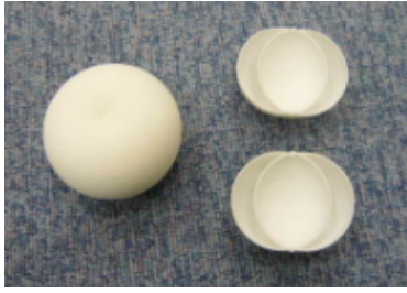
図5 スピンドルトーラスとその分割 d = 0.625 \text{ cm} , r = 2.5 \text{ cm} レーザー焼結法 (材料: ナイロン粉末)
