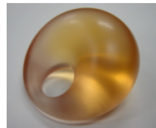
図2 サイクライド曲面 (光造形法) : 現代の技術を使えば、図1と同様の模型を一流数学者や熟練工に頼らずに造れる。
