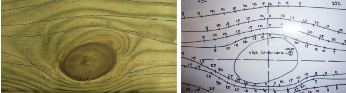
FIGURE 1.8 – Déviation des fibres autour des noeuds (Baño et al. , 2011) [3]
