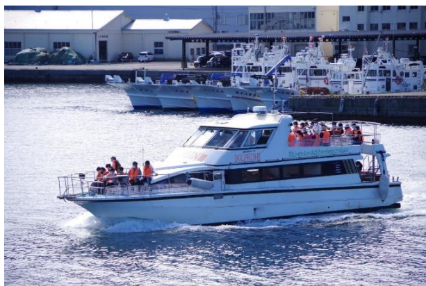
「DOLPHEN III」19GT 乗客定員48名 最大速力30ノット
